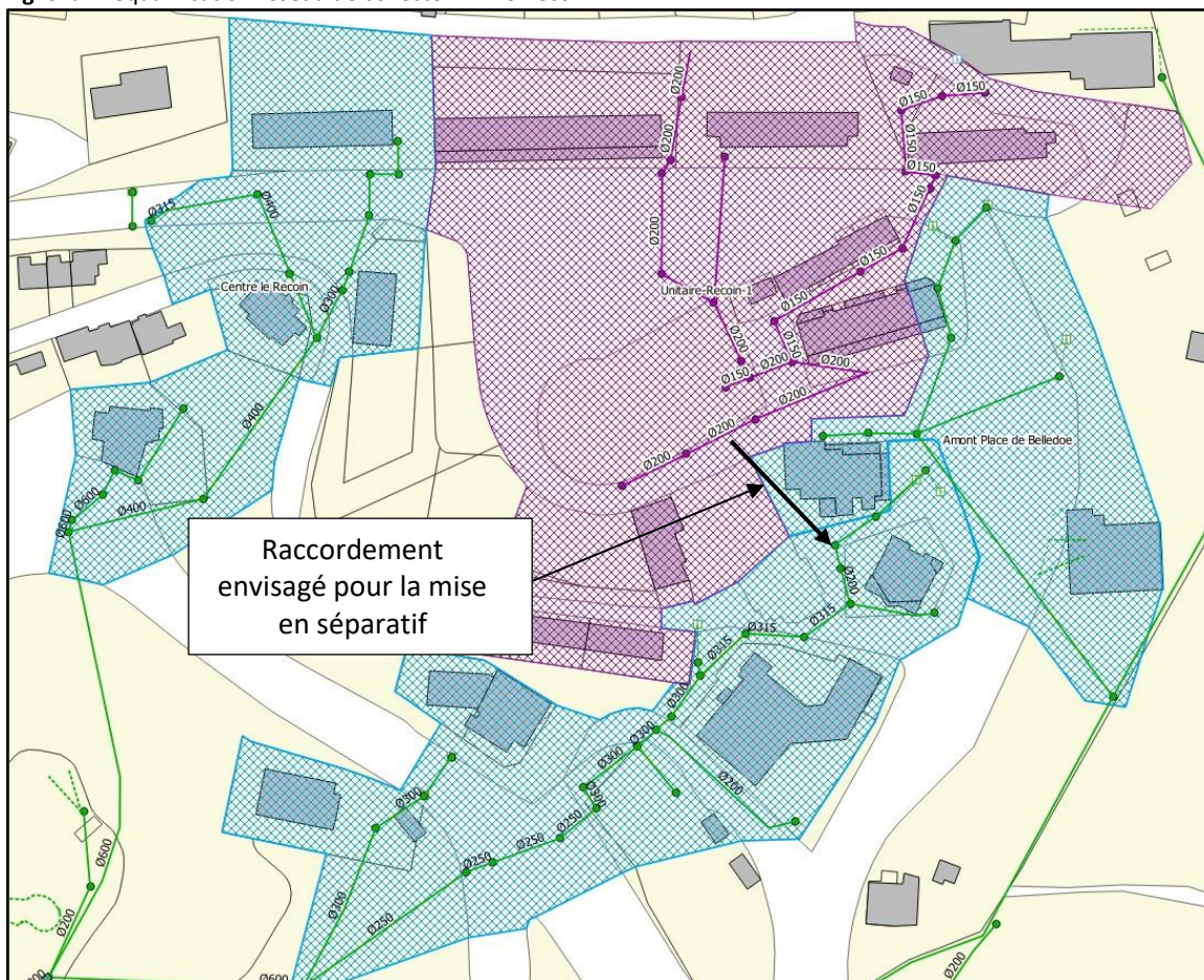
Fig. 5-b : Requalification réseau de collecte EP - Le Recoin
